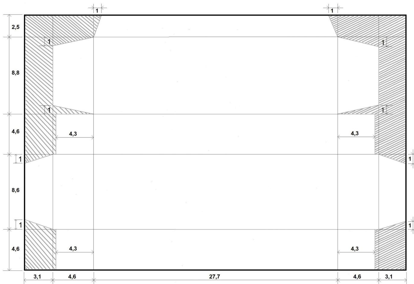
Les procédures de traçage, de mise en forme et de pliages sont identique à celles effectuées pour la partie intérieure de calage (dimensions 43,1 cm x 29,1 cm). Tous les plis sont réalisés sur l'endroit. Attention avant les découpes de respecter le sens des rabats et recouvrements.
