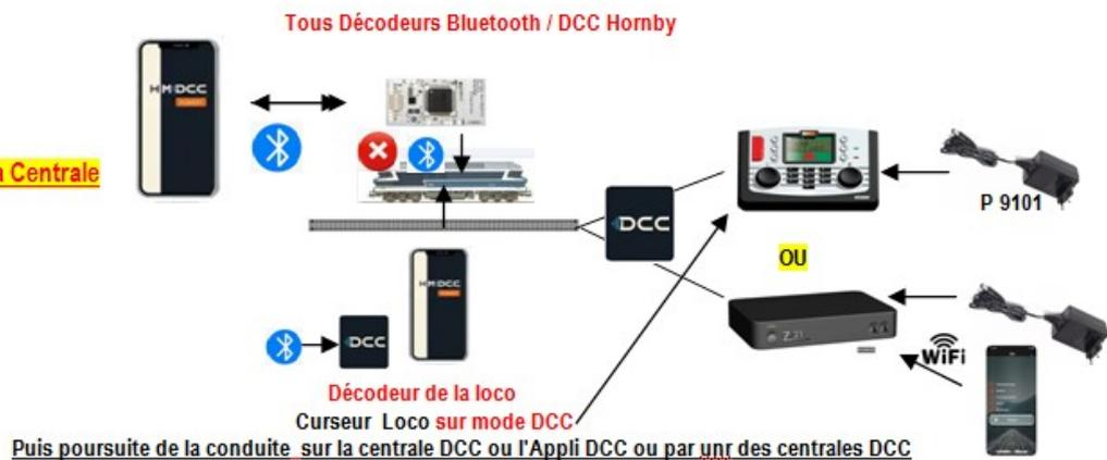
Bien sur l'Application ne peut pas fonctionner seule car une **alimentation DCC de la voie** via une source DCC sera nécessaire.
